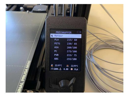
Les différents paramètres présents ici permettent de modifier les températures des types de filament lors de l'utilisation de ceux-ci pour des impressions.
